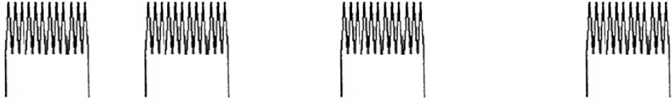
Şekil 5.2: Stator bobinler arasındaki mesafenin artış şekli.
