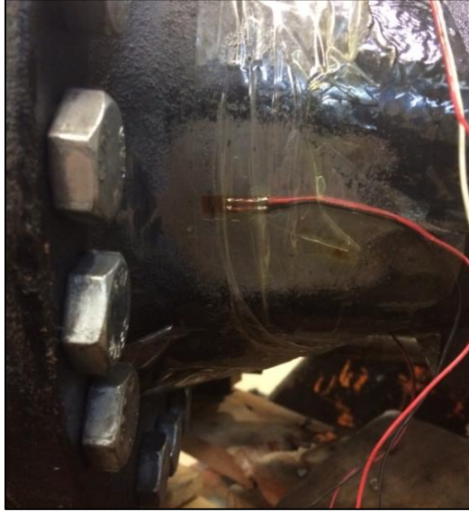
Şekil 7.6: Strain-gauge bağlantı bölgeleri (sağ taraf ön aks alt yüzey).
