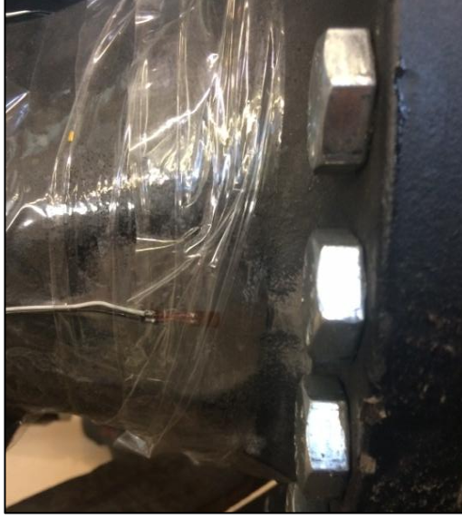
Şekil 7.5: Strain gauge bağlantı bölgeleri (sol taraf ön aks alt yüzey).
