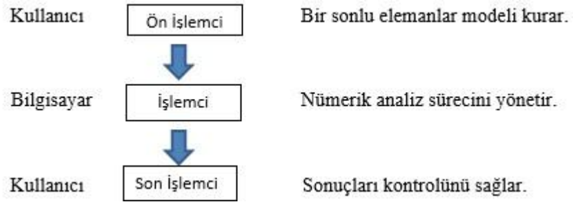
Şekil 4.3: Programlardaki sonlu elemanlar analiz prosedürü [5].
