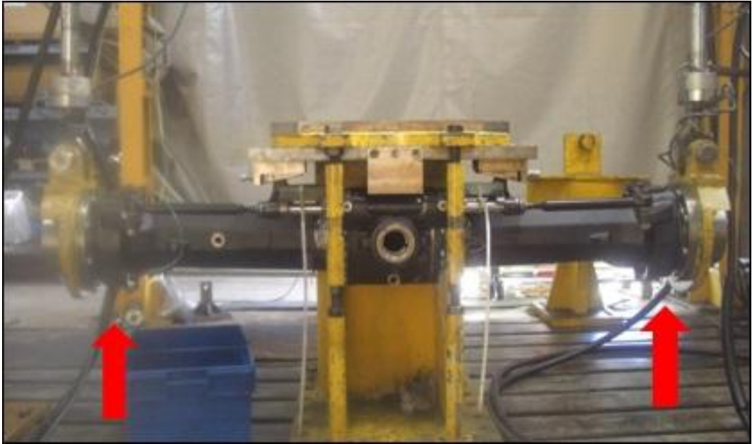
Şekil 7.4: Ön Aks kompleksinin piston ve mesnet bağlantısı.
