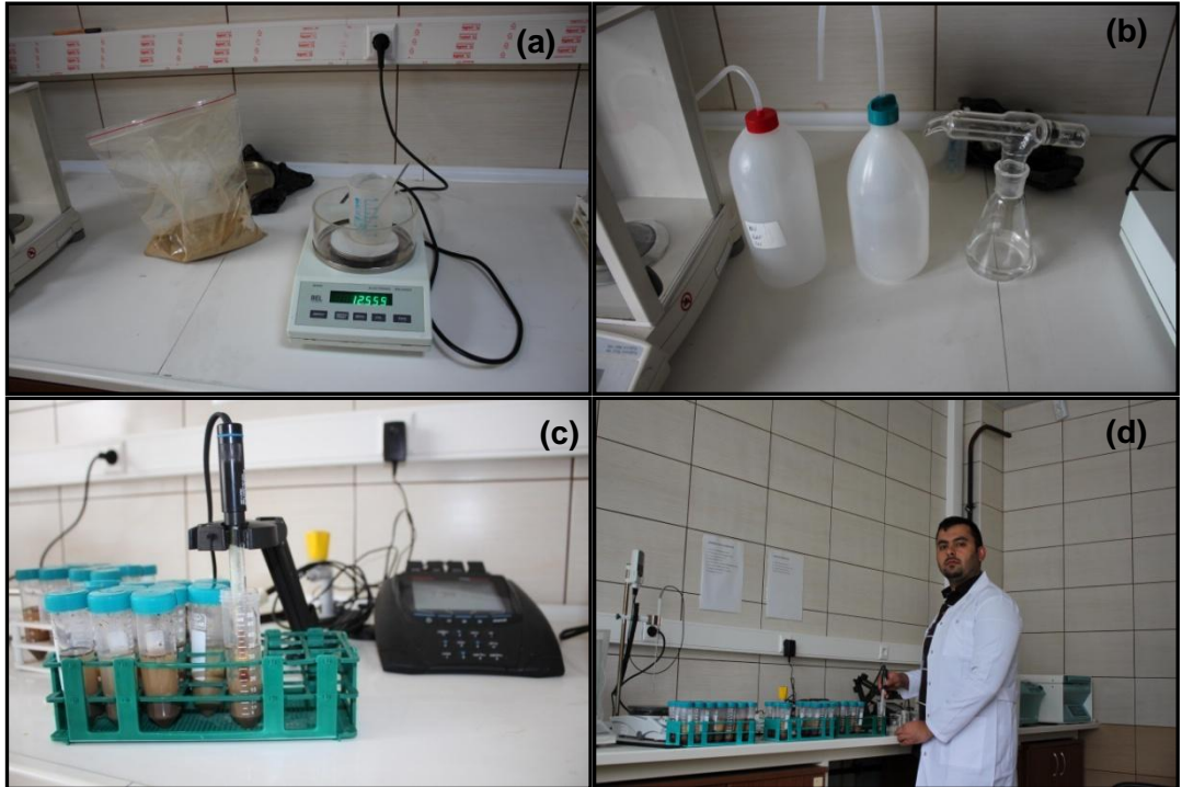
Şekil 10. a) Örneklerin hassas tartımında kullanılan hassas terazi, b) Saf su ve 25ml'lik beher, c) Cam elektrotlu pH metre, d) pH ölçüm işlemi
