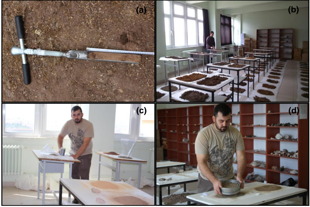
Şekil 6. a) Toprak örneklerinin alınması, b) toprak örneklerinin kurutulması, c) örneklerin öğütülmesi ve d) örneklerin 2 mm elekten geçirilmesi
