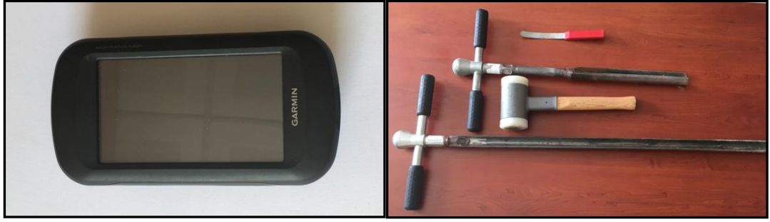
Şekil 4. a) Garmin 600t el tipi GPS cihazı, b) Eijkelkamp 30cm ve 100cm sert toprak burgu seti
