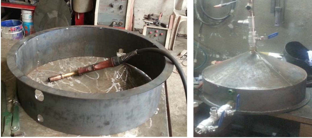
Őekil 2.3: Reaktr tankı imalatı.
