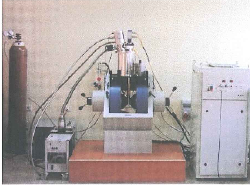
Şekil 5.1 Gazi Üniversitesi STARLAB da bulunan kapalı-devirli He soğutuculu Lake Shore Hall Etkisi ölçüm sistemi
