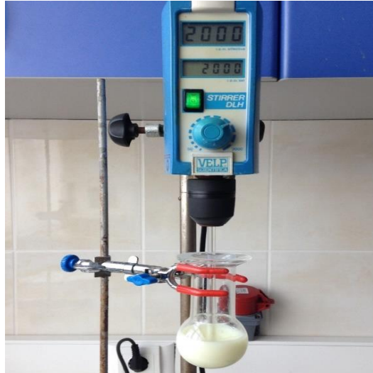
Şekil 3.1: HoVO 4 nanoparçacıklarının sentezinde kullanılan reaksiyon sistemi.
