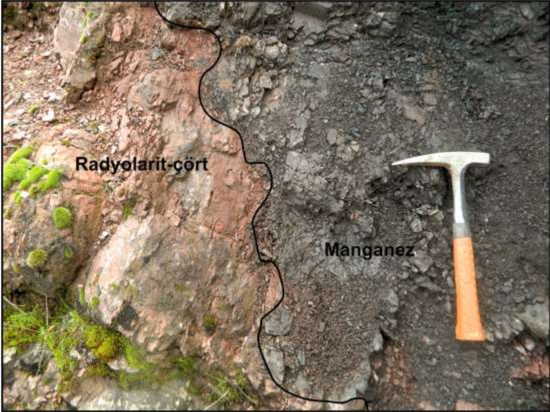
Şekil 6.6: Radyolarit-çört litolojisiyle keskin kontaklı manganez cevherleşmesi
