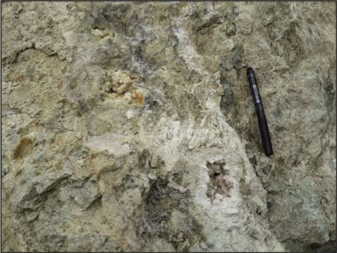
Şekil 4.6: Çalışma alanında Kula-Pabuçlu yolunun doğru kesiminde Köprü Tepe civarındaki aşırı altere serpentinitlerin yakından görünümü
