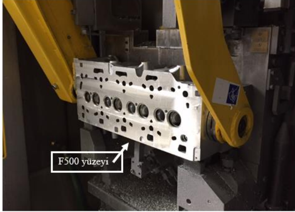
Resim 4.6: Op 330 İşleme makinası iç görünüşü
