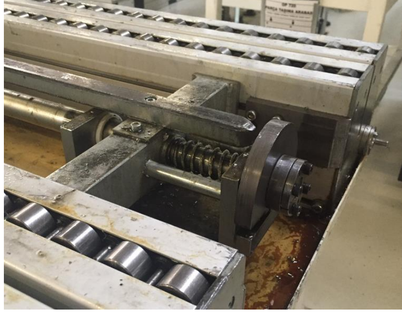
Resim 4.8: Taşıma arabası kilitleme mekanizması.
