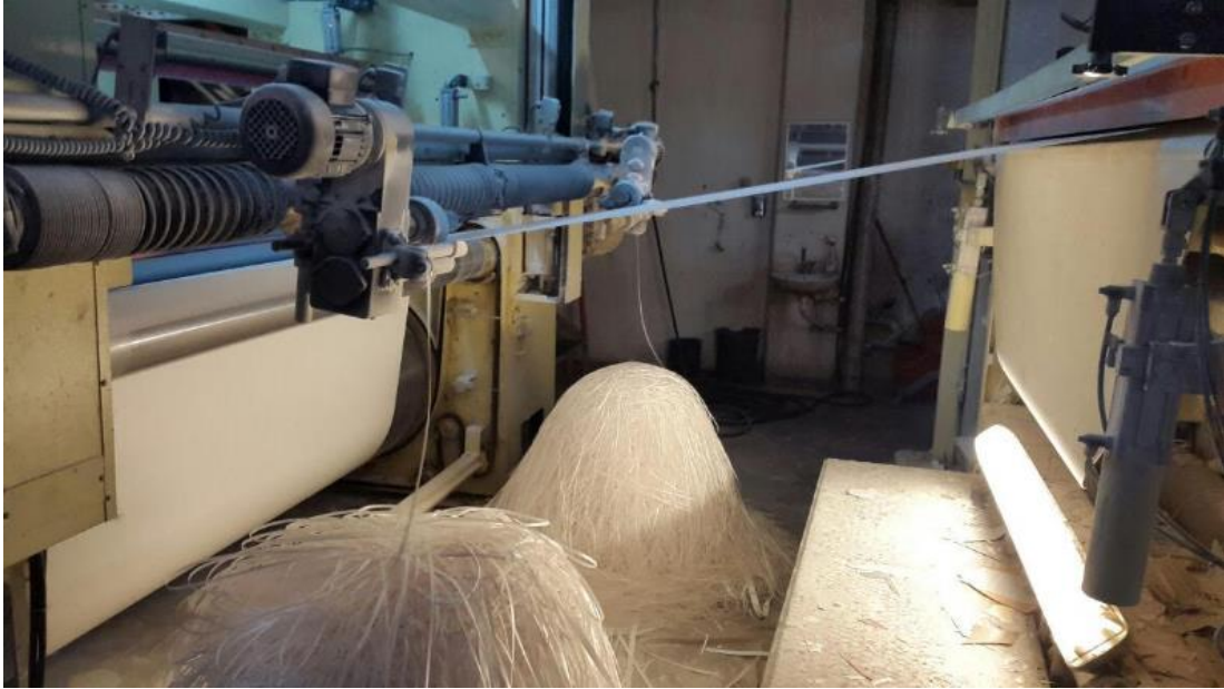
Şekil 4.3: Emprenye edilmiş dekor kâğıtlarının ebatlama ve istif öncesi kenar kesimi.
