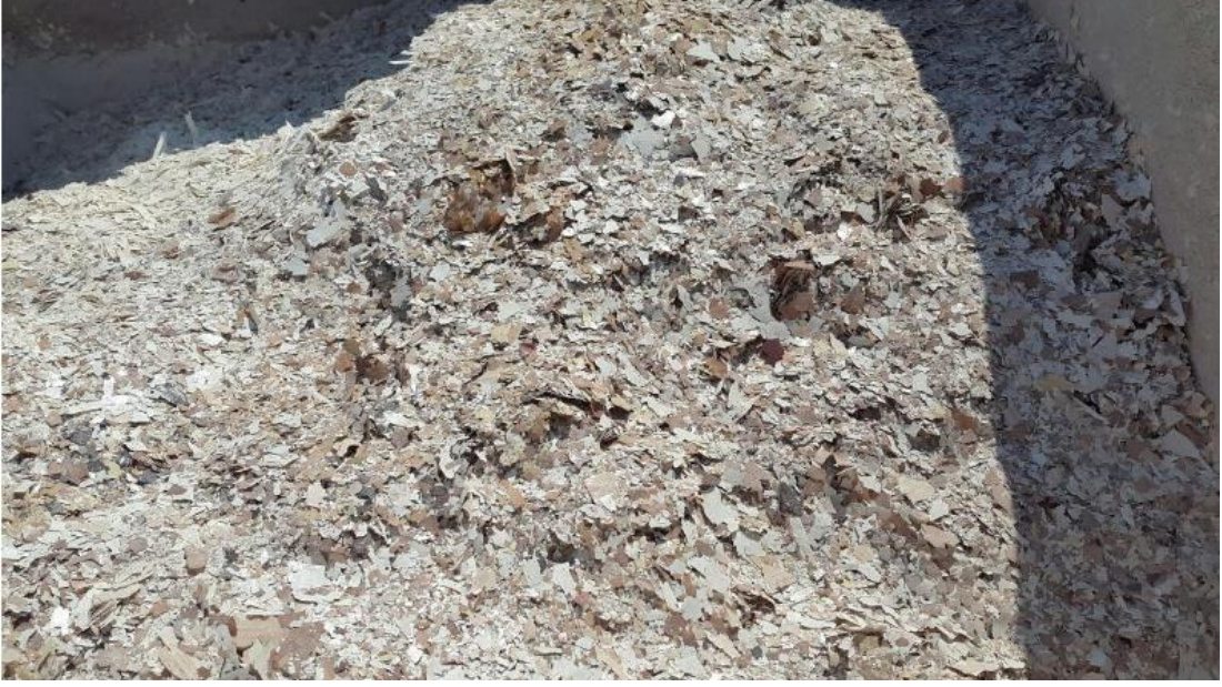
Şekil 4.4: Kenar kesme işleminden sonra vakum ile taşınan ve kırık vaziyette depolanan reçineli kâğıt parçaları.
