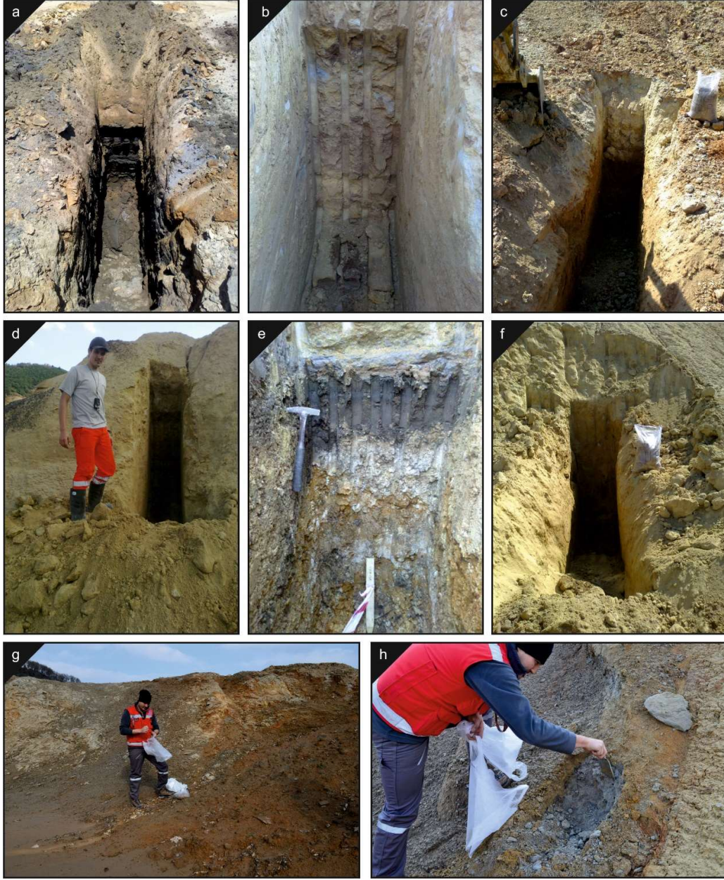
Şekil 5. 5: Flotasyon atık bölgelerinin numunelendirme çalışması; a-b-c-d) kanal tipi numune alımını gösteren fotoğraflar. g) Numune alımı sırasında lokasyon etiketleme yöntemini gösteren resim, h) Numune alım şeklini gösteren fotoğraf.
