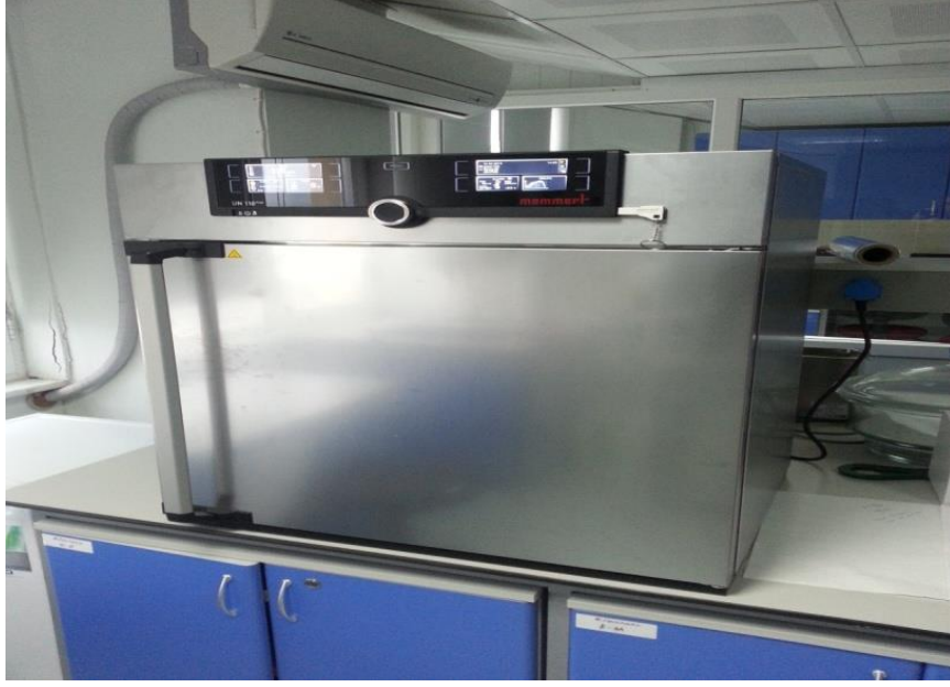
Şekil 3.2: Reaksiyonun gerçekleştirildiği ve reaktörlerin içine konulduğu etüvün gösterimi.
