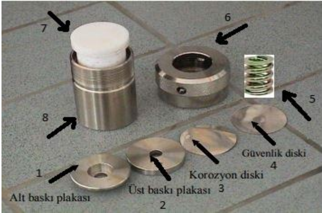
Şekil 3.1: Reaktör oluşturan parçaları: (1) Alt baskı plakası, (2) Üst baskı plakası, (3) Korozyon diskisi, (4) Güvenlik diskisi, (5) Düşük ve yüksek basınç plakalarını dengeleyici yay, (6) Reaktörün dış kapağı, (7) Çözeltinin bulunduğu teflon kap, (8) Paslanmaz reaktör kabı
