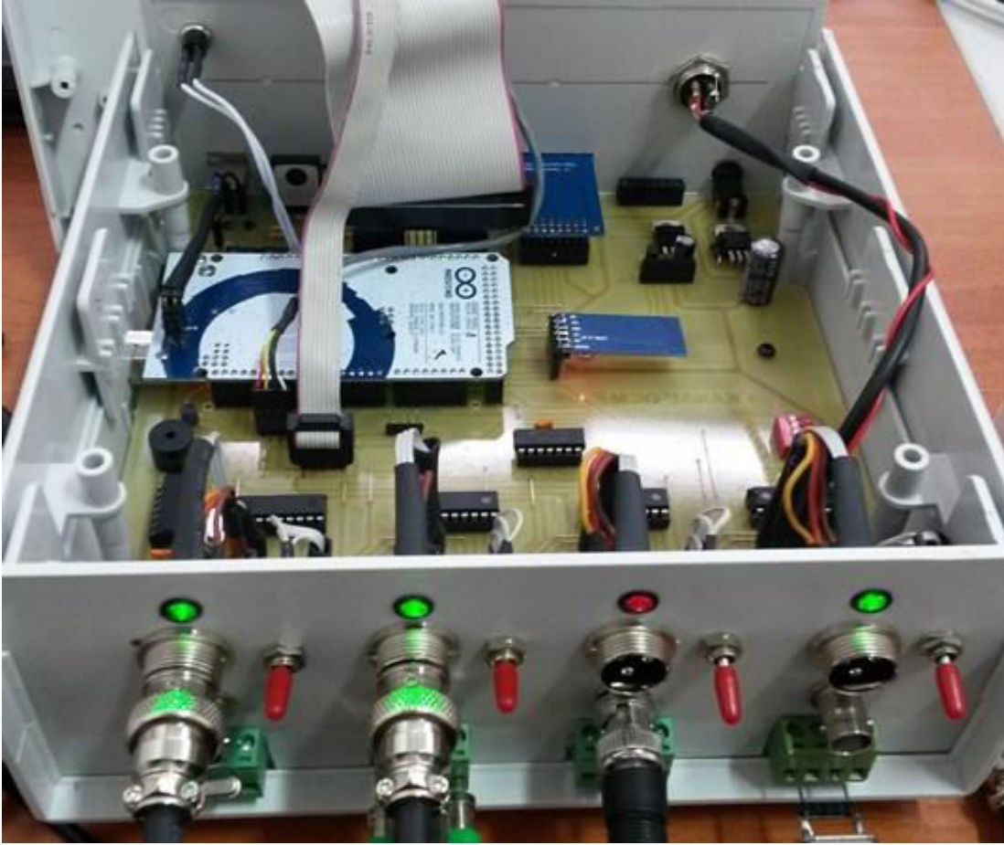
Şekil 3.32: KKM ölçüm cihazının içyapısı.
