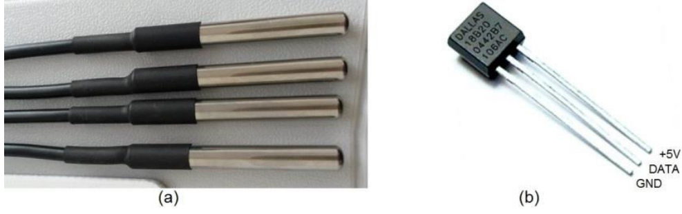
Şekil 3.11: a) Metal kılıf içine alınmış DS18B20 sensörleri, b) DS18B20'nin dış görünüşü.
