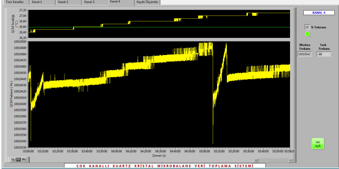
Şekil 4.6: Bir yüzeyine de-iyonize su damlatılan KKM kristalinin frekans tepkisi.
