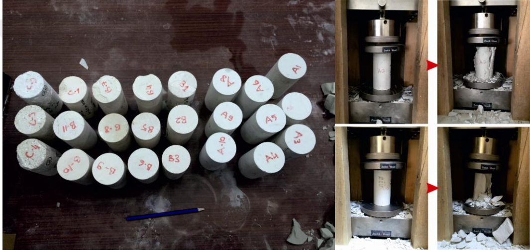
Şekil 3.16: Gölet alanında yapılan sondajlardan alınan karotlar.
