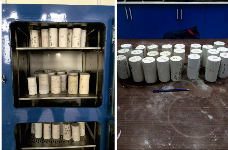
Şekil 2.19: Deney için sondajlardan alınan karot örnekleri.
