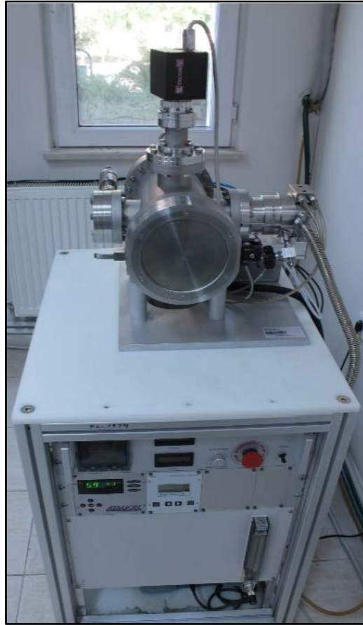
Şekil 5.12: Hızlı ısıtılma (RTA) sistemi.
