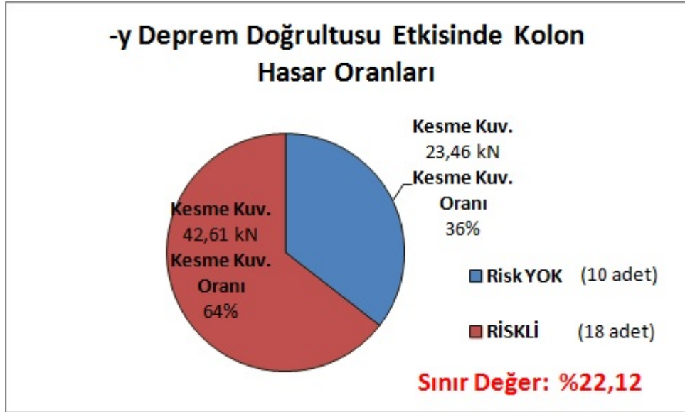
Şekil 8.12: -y deprem doğrultusu etkisinde kolon hasar oranları
