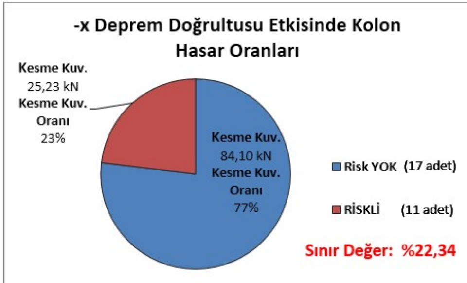
Şekil 8.10: -x Deprem doğrultusu etkisinde kolon hasar oranları
