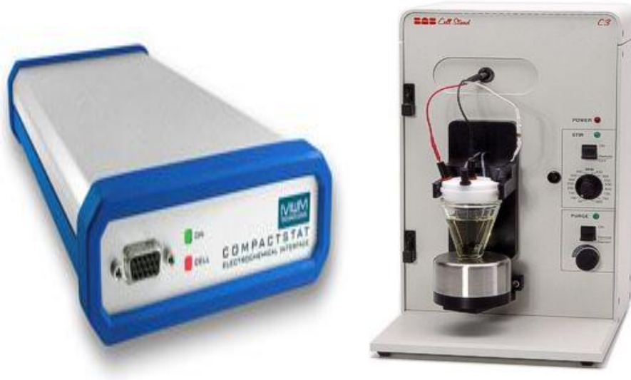
Şekil 2.1: Basi C3 hücre standı ve İvium Compact stat potansiyostat/galvanostat
