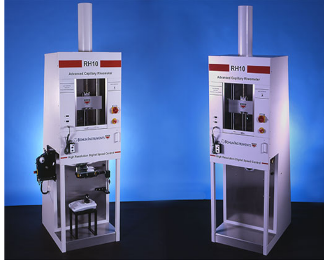
Şekil 2.2 Deneylerde kullanılan yüksek basınçlı kapiler reometre
