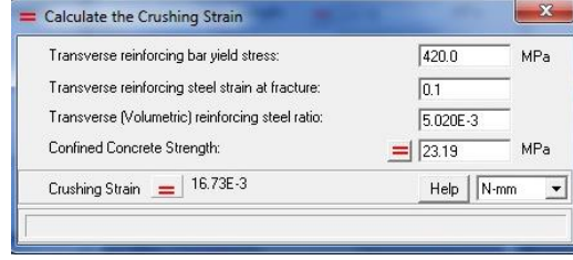
Şekil 4.9: Çekirdek betonu ezilme şekil değiştirmesi
