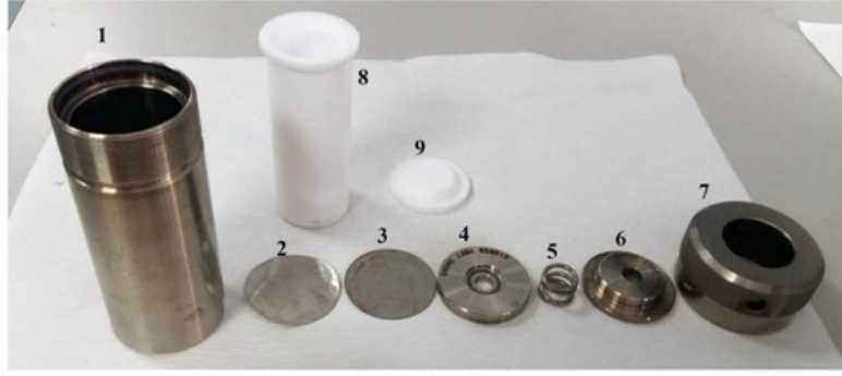
Şekil 2.2: Hidrotermal kristal büyümesi için otoklav cihazı.
