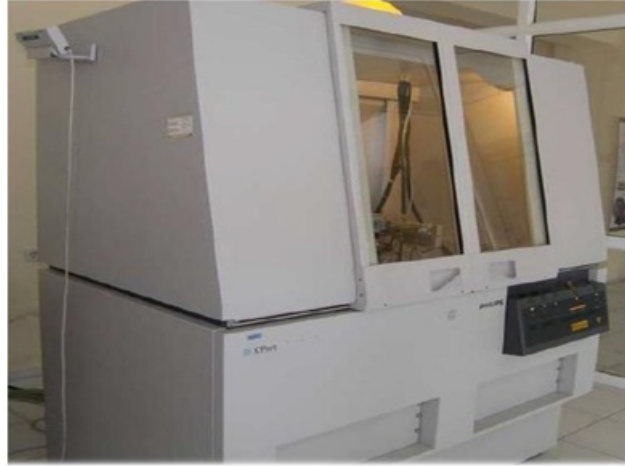
Şekil 3.3: Philips X'Pert Pro toz kırınımı ölçüm cihazı.
