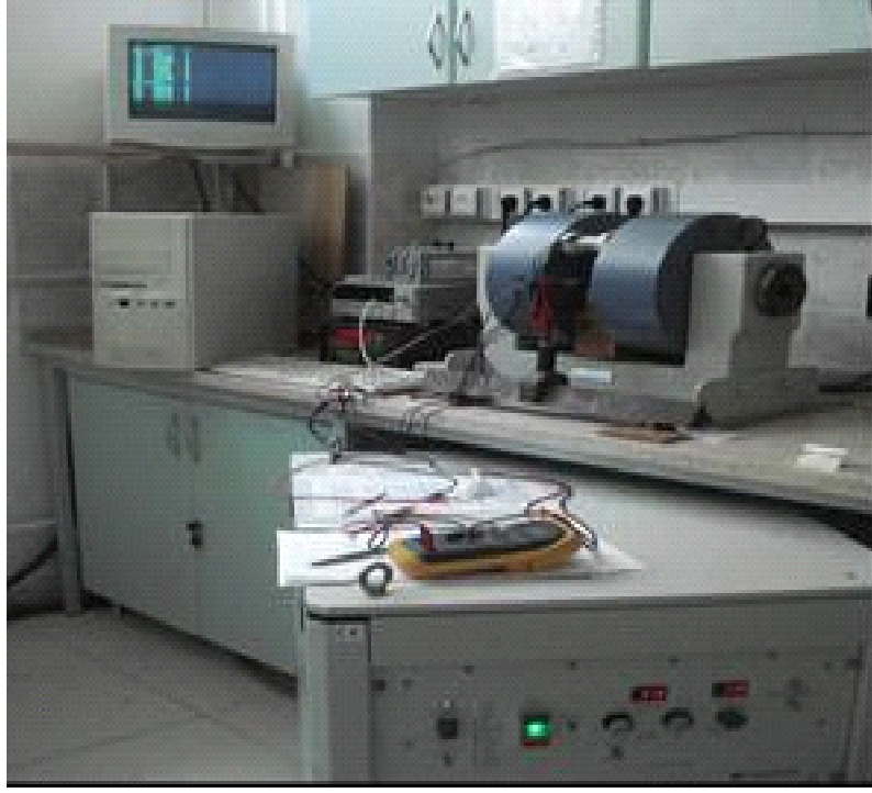
Şekil 3.5: Manyetik direnç ölçüm sistemi
