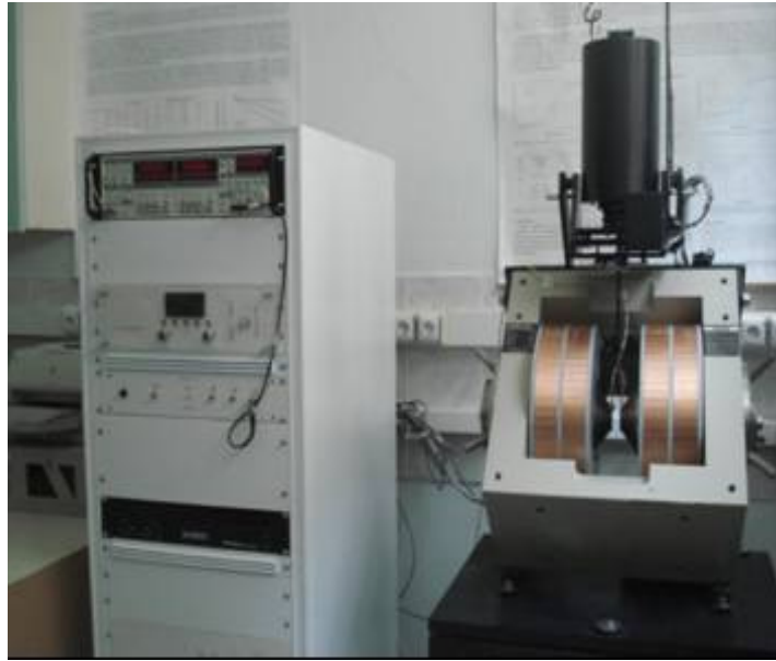
Şekil 3.6: Manyetik ölçümler için kullanılan Titreřimli Numune Magnetometresi
