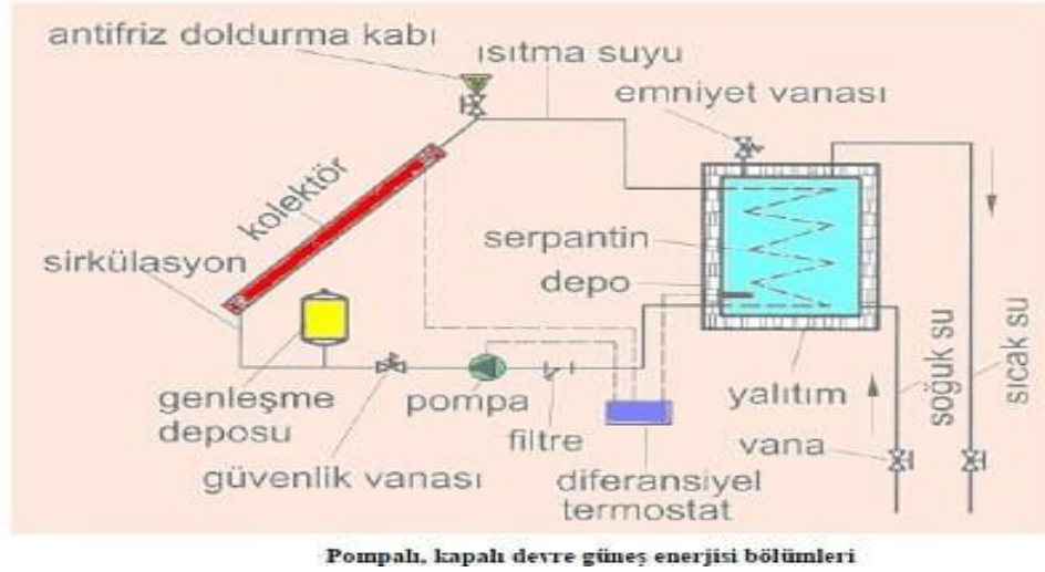
Şekil 2.4: Cebri dolaşımli kapalı devreli sistemlerin şeması [45]
