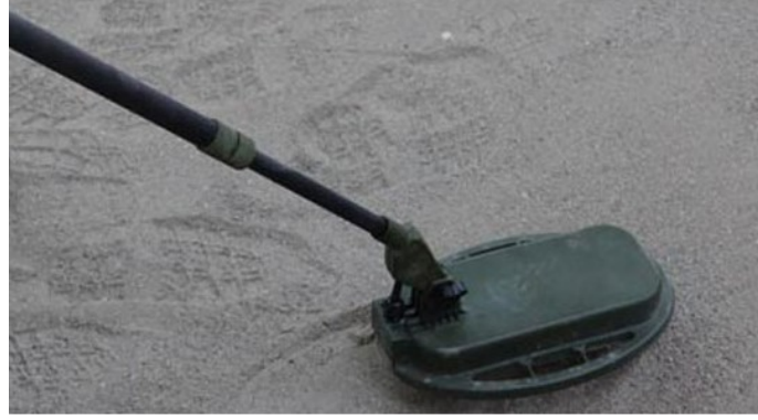
Şekil 2.7: TÜBİTAK ETMS-2 GPR özellikli mayın ve EYP tespit sistemi [55].
