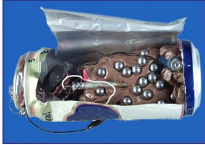
Şekil 2.4: Sarsıntı ile devreye giren EYP düzenegi.
