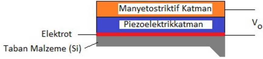
Şekil 2.12: ME sensörün yapısı.
