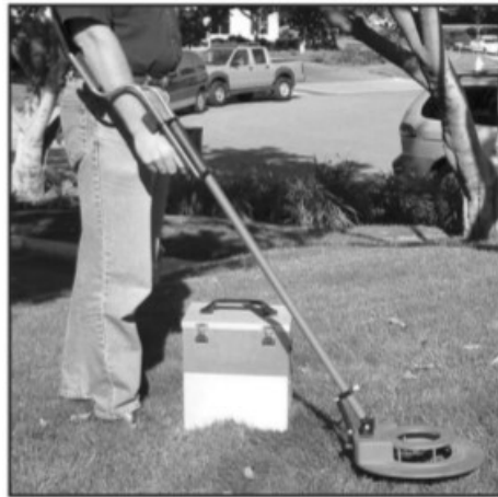
Şekil 2.8: Taşınabilir NQR mayın detektörü [74].
