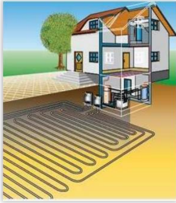
Şekil 3.6: Yatay tip topraklı ısı pompası şematik gösterimi [24]
