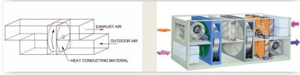
Şekil 2.2: Tamburlu (ısı tekerli) ısı geri kazanım ünitesi [20]
