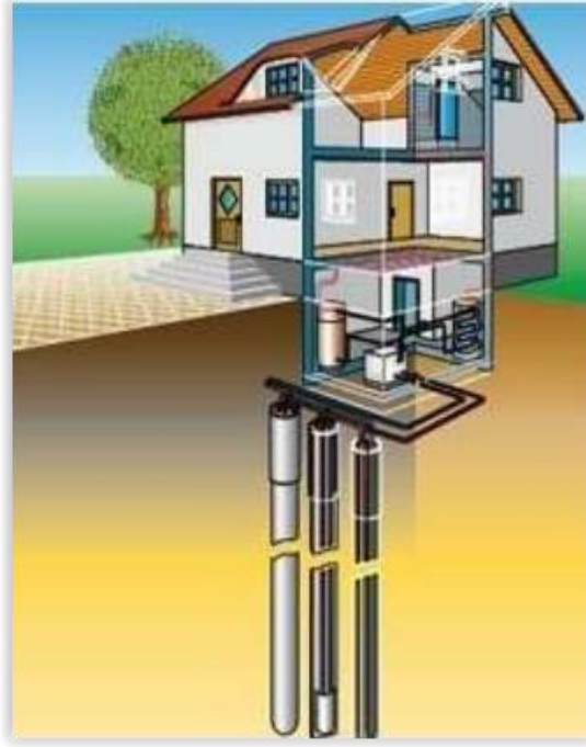
Şekil 3.7: Dikey tip ısı pompası şematik gösterimi [24]
