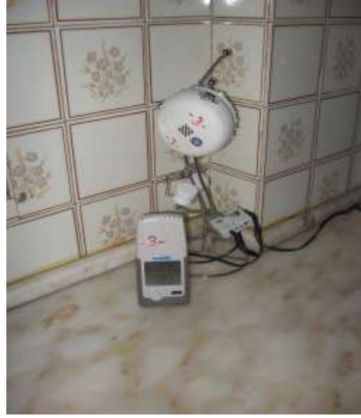
Şekil 2.2: Telaire 7001 CO 2 /sıcaklık ve PM monitörü
