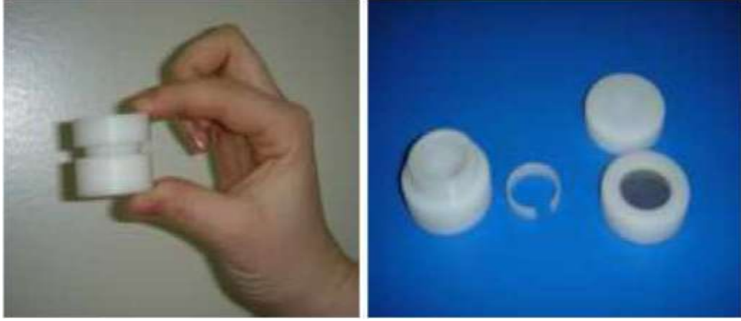
Şekil 2.7: Pasif örnekleyici parçaları [116]
