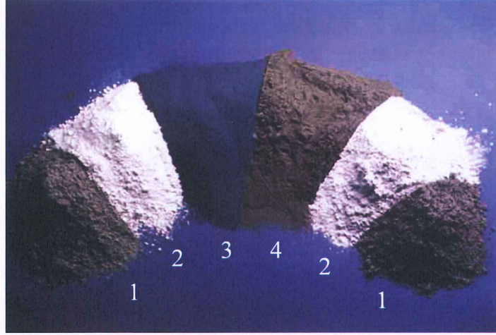
Şekil 2.1: Mineral katkı maddeleri: 1) Çimento; 2) Granüle yüksek fırın cürufu; 3) Silis Dumanı; 4) Uçucu Kül
