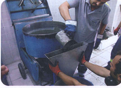
Şekil 3.3: V Hunisi deneyi aşamaları
