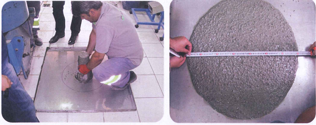
Şekil 3.1: Çökme yayılma deneyinin yapılışı ve sonucu
