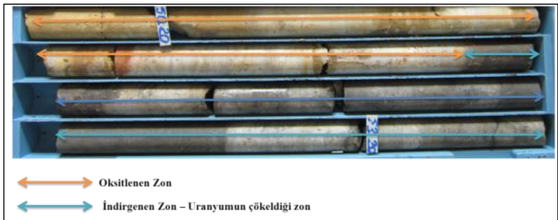
Şekil 5.1: Oksidasyon-Redüksiyon geçiş zonları ve uranyum cevherleşmesi
