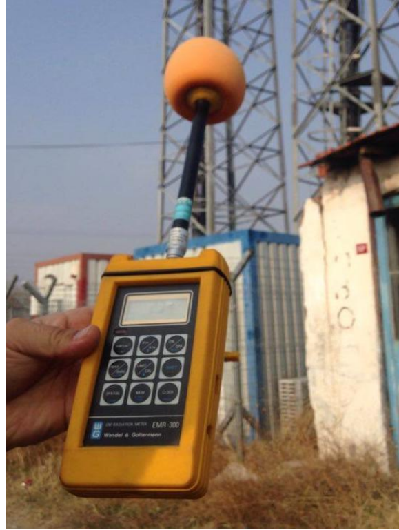
Şekil 4.21: Narda EMR-300 cihazı ve P/N2244/90.73 tipli prob
