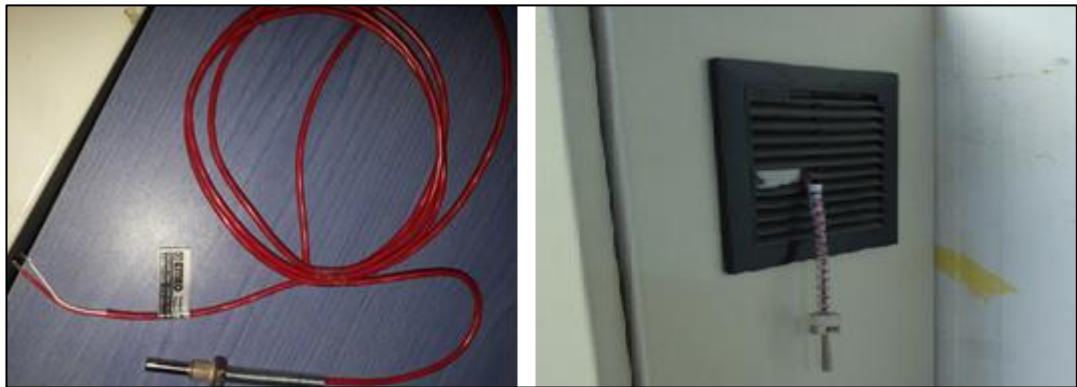
Şekil 5.11: PT100 sıcaklık duyargası ve kontrol panosuna konumlandırılmış dış ortam ölçümünde kullanılan sıcaklık duyargası
