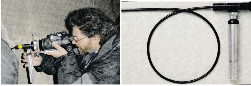
Şekil 3.57: Endoskopik yöntemle hasar tespiti [78]
