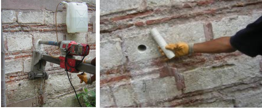
Şekil 3.58: Yapı malzemesinden karot alma [73]
