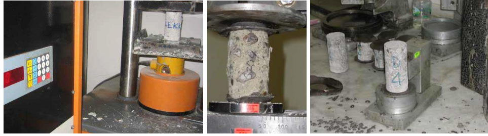
Şekil 3.59: Karot numunelerin tek eksenli basınç deneyi [74]
