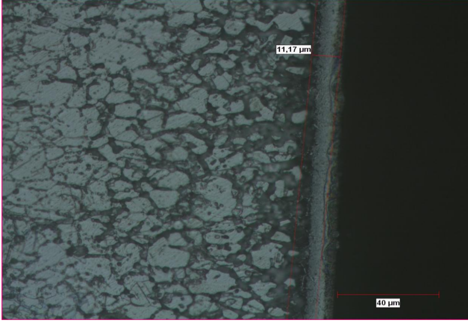
Şekil 8.5: 850 °C de 2 saat borlanan AISI 304 malzemesinin mikroyapı görüntüsü
