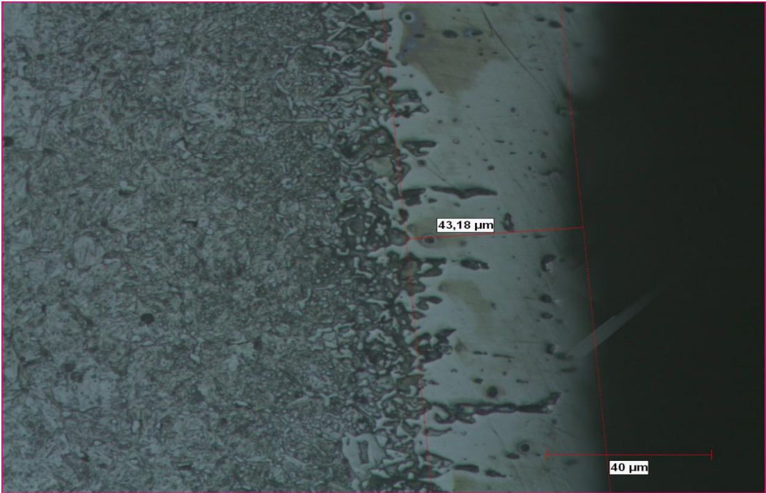
Şekil 8.29: 1000°C de 4 saat borlanan AISI 420 malzemesinin mikroyapı görüntüsü
