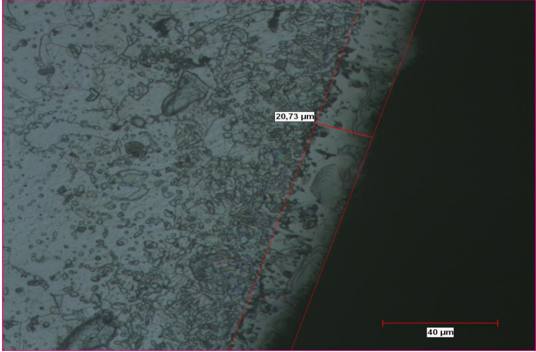
Şekil 8.27: 1000°C de 2 saat borlanan AISI 430 malzemesinin mikroyapı görüntüsü
