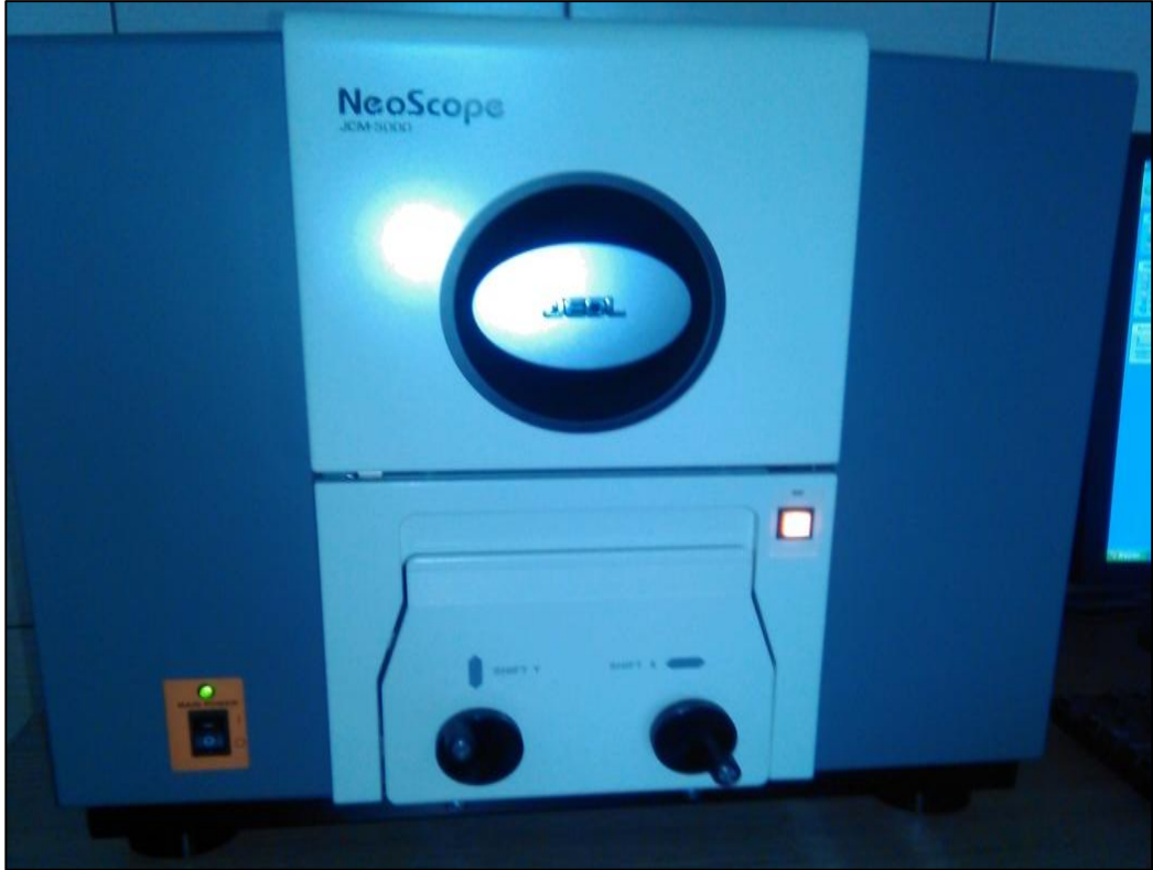
Şekil 3.2: Mikromorfolojik çalışmalarda kullanılan Masa üstü SEM (JCM-5000) cihazının genel görüntüsü.
