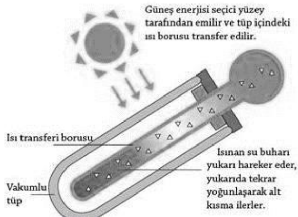
Şekil 1.25: Vakum tüplü güneş kolektörü.
