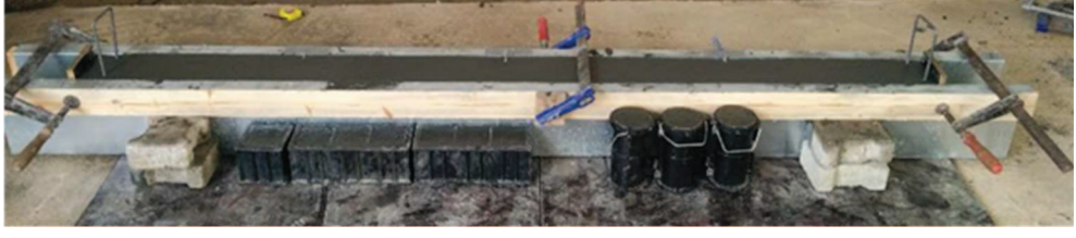
Şekil 2.20: Dökümü tamamlanmış test kirişi
