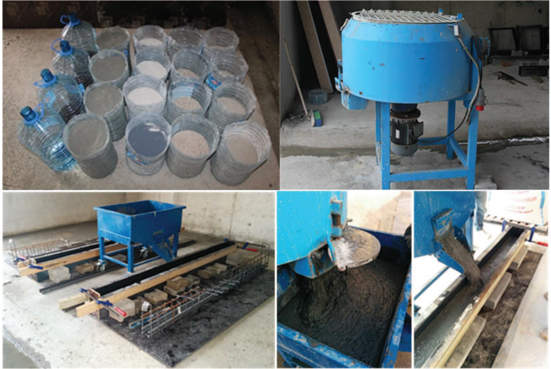
Şekil 2.19: UYPLB’un hazırlanması ve kiriş kalıplarına yerleştirilmesi
