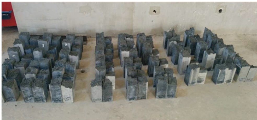
Şekil 2.9: Testleri tamamlanan prizma numuneler
