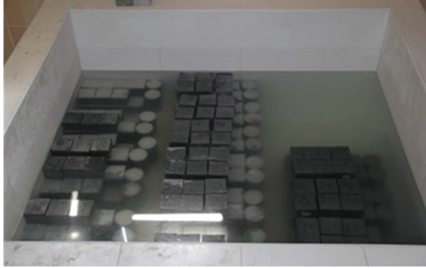
Şekil 2.5: Kür havuzundaki test numuneleri
