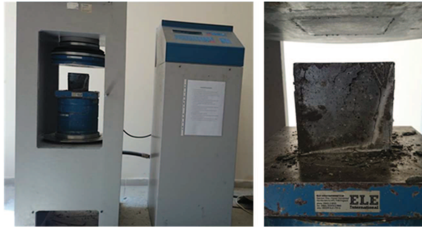
Şekil 2.6: Numunelerin beton basınç dayanımlarının belirlenmesi
