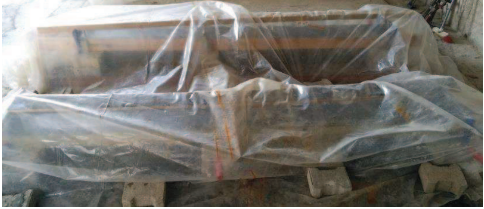
Şekil 2.21: Plastik örtü ile sarılmış test kirişleri
