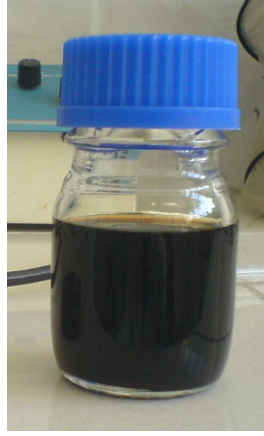
Şekil 3.5 Manyetit nanoparçacıkların kararlı dispersiyonu
