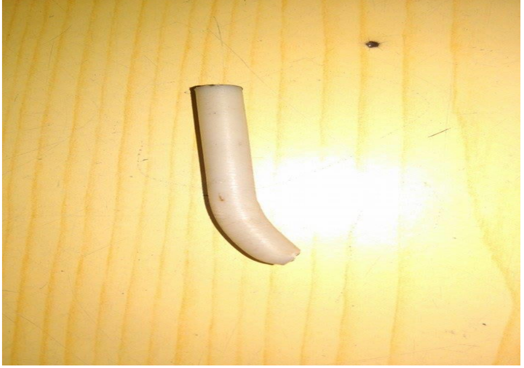
Şekil E: Aşınma testi sonrası pim görünümü.
