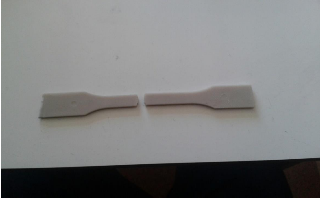
Şekil D: Çekme deneyi sonucu görseli.
