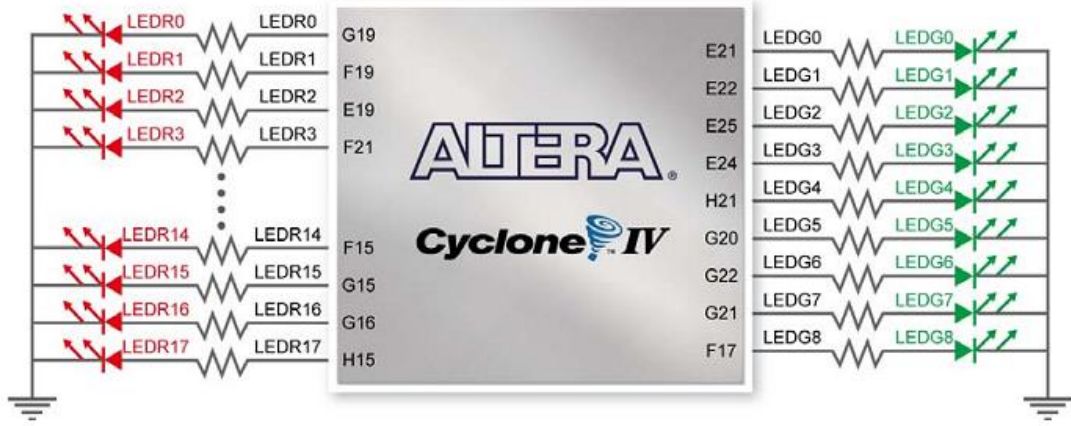
Şekil 4.9: LED ve Cyclone IV E FPGA arasındaki bağlantılar
