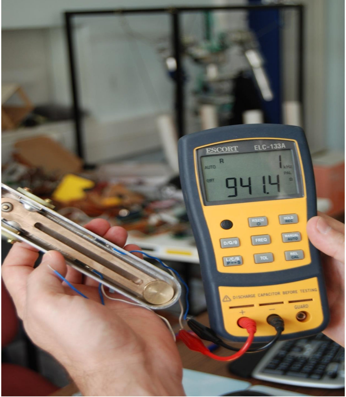
Şekil 6.15: Eğim ölçerin sol yatay konumda okuduğu değer
