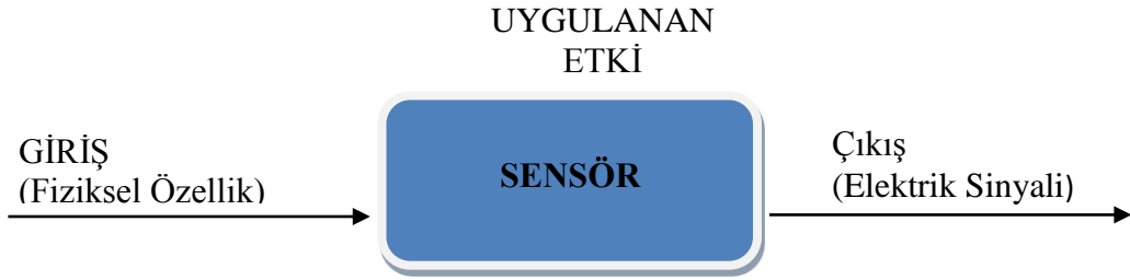
Şekil 2.1: Sensörlerin çalışma prensibi
