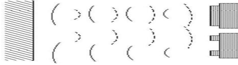
Şekil 4.43: Ultrasonik ses dalgalarının yayılımı
