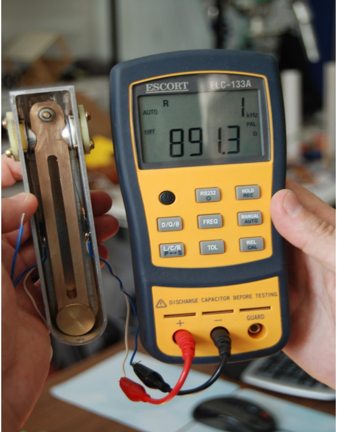
Şekil 6.13: Eğim ölçerin orta konumda iken okuduğu değer
