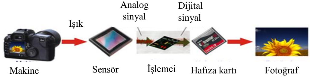
Şekil 4.27: Dijital fotoğrafın temel işleyişi
