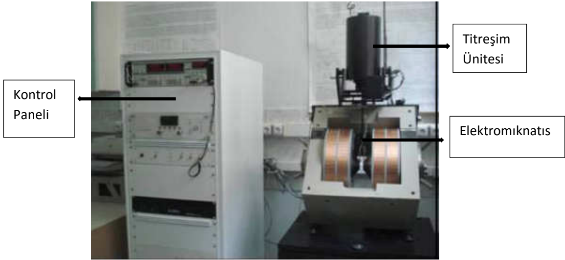
Şekil 3.7: VSM'in titreşim ünitesi, elektromıknatis ve kontrol paneli.
