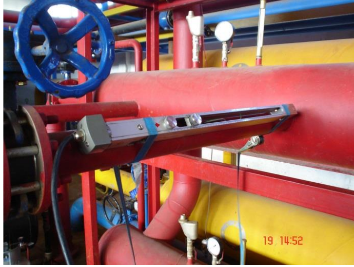
Şekil 4.21: Fethibey Mahallesi ısıtma zonu eşanjör çıkışında hat debisi ölçüm çalışması.
