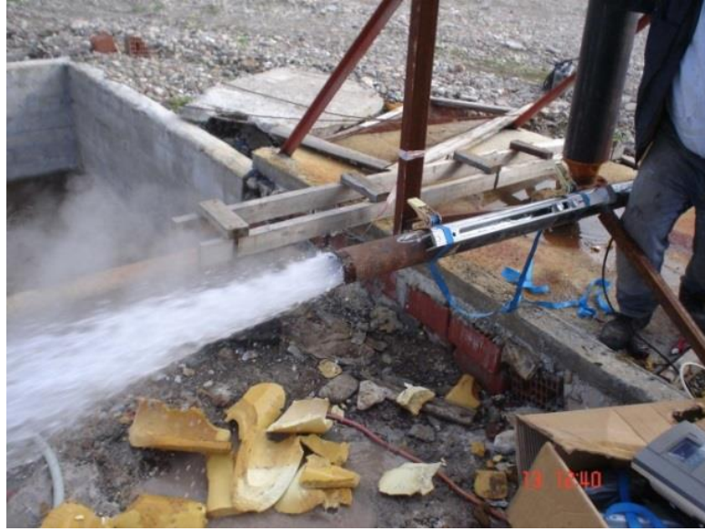
Şekil 4.16: HK-8 kuyusu çamur separatörü çıkışında kuyu debisi ölçüm çalışması.
