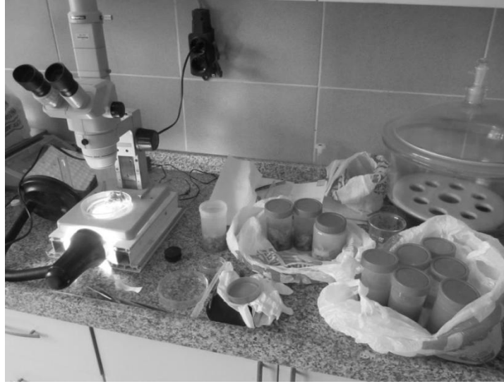
Şekil 2.3: Parazitolojik incelemede kullanılan Olympus SZ4045 stereomikroskop.
