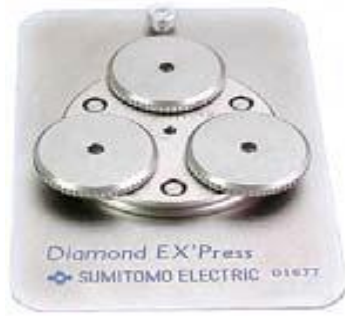
Şekil 1.39: Elmas sıkırtırmalı hücre
