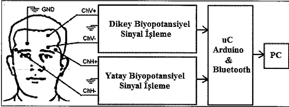
Şekil 3.1: Elektrot bağlantısı ve sistemin blok gösterimi.
