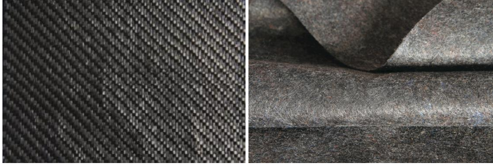
Şekil 2.1: Örgülü (sol taraf) ve örgüsüz (sağ taraf) geotekstil örneği.
