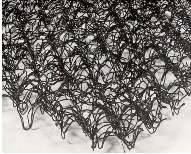
Şekil 2.7: Erozyon kontrol matı örneğı.
