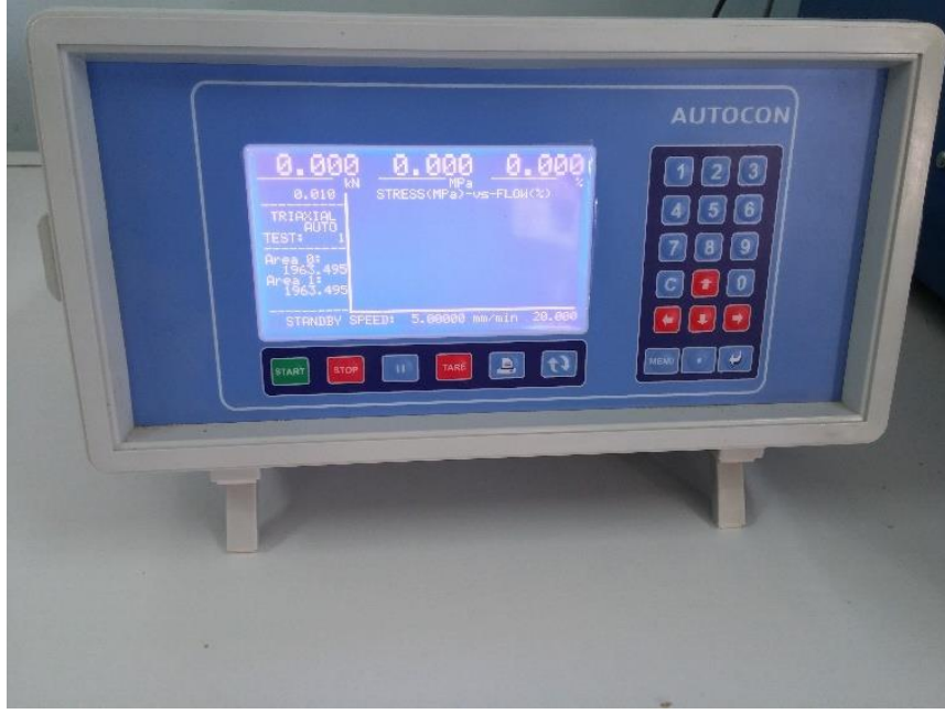
Şekil 5.16: Veri edinim ünitesi.
