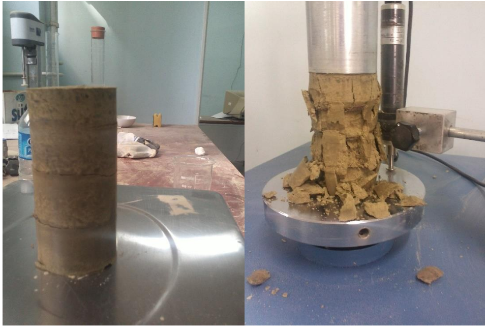
Şekil 5.26: Üç tabakalı geotekstil ile hazırlanmış zemin örneği ve kırılma şekli.
