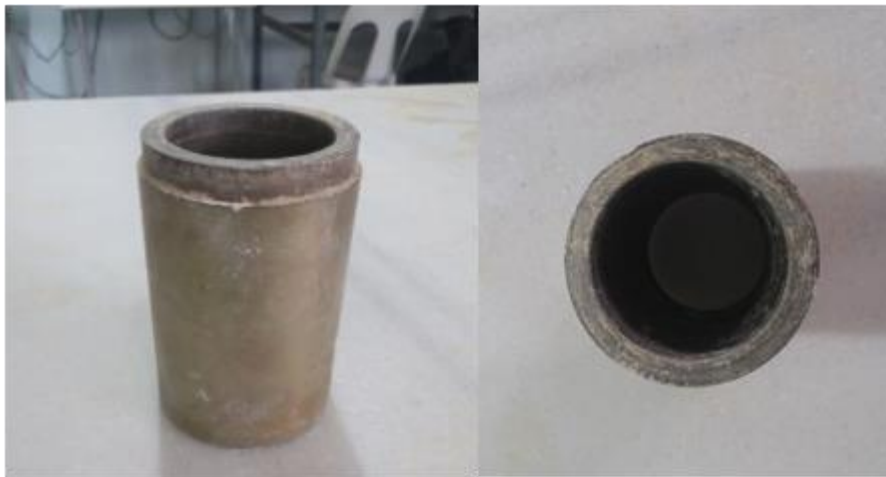
Şekil 5.1: Numune hazırlamak için kullanılan kalıp.
