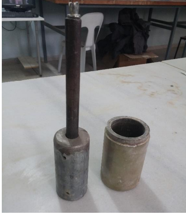
Şekil 5.12: Numuneyi sıkıştırmak için kullanılan tokmak ve kalıp.
