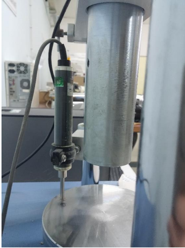
Şekil 5.15: Doğrusal potansiyometrik cetvel.
