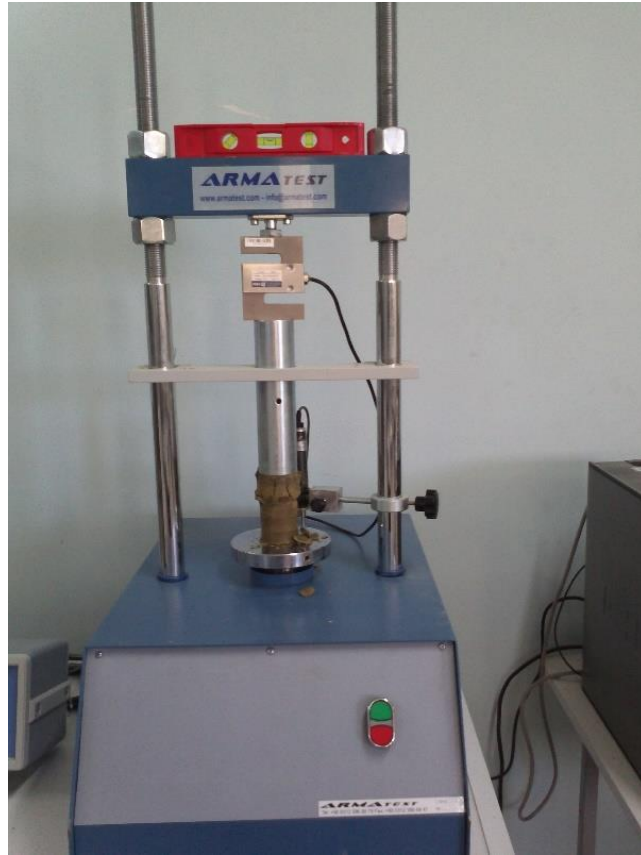
Şekil 5.13: Serbest basınç deney aleti.
