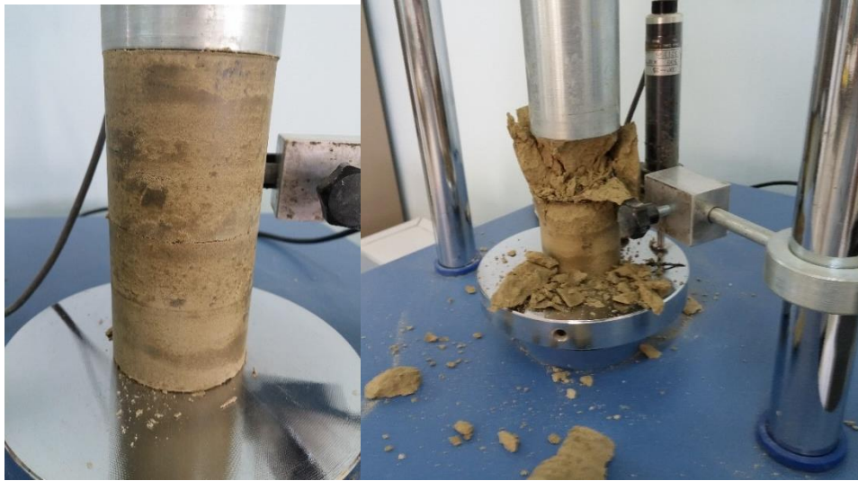
Şekil 5.24: Tek tabakalı geotekstil ile hazırlanmış zemin örneği ve kırılma şekli.
