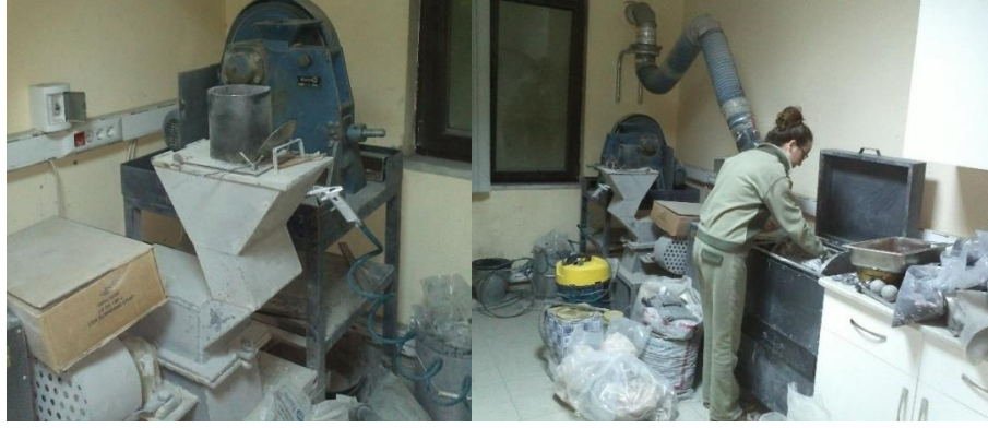
Şekil 5.18: Numunenin değirmende öğütülmesi.
