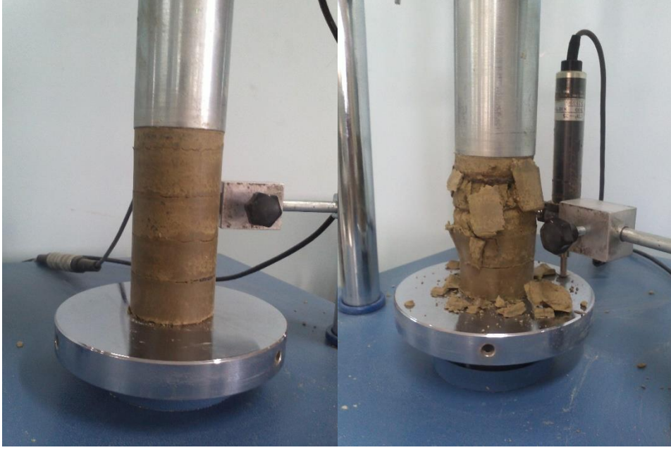
Şekil 5.27: Dört tabakalı geotekstil ile hazırlanmış zemin örneği ve kırılma şekli.
