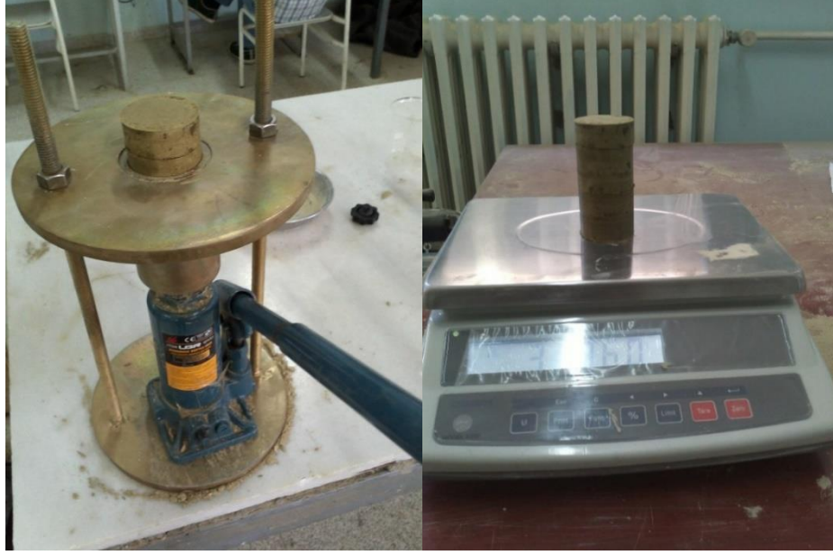
Şekil 5.21: Numunenin kalıptan çıkartılması ve tartılması.
