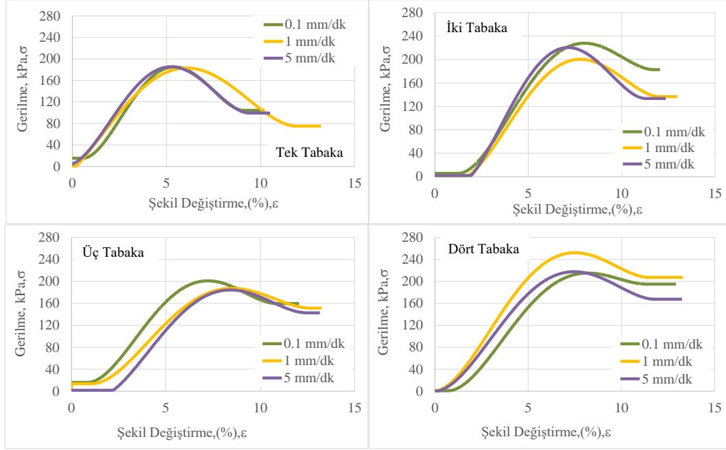
Şekil 6.12: G1 türü geotekstil kullanılan deneylerde farklı tabaka sayıları için yükleme hızı etkisinin karşılaştırılması.
