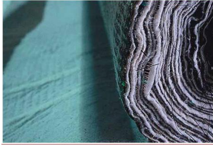
Şekil 2.5: Geosentetik kil örtüsü örneği.
