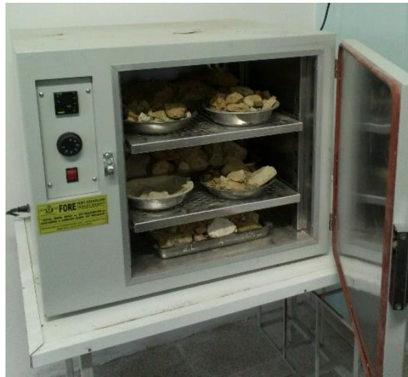
Şekil 5.17: Etüvde kurumaya bırakılan zemin örnekleri.
