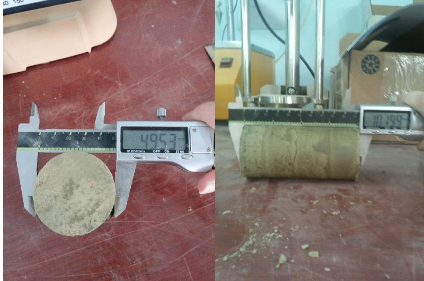
Şekil 5.22: Numunenin elektronik kumpas kullanılarak ölçülmesi.
