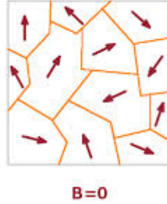
Şekil 2.6: Ferromanyetik katıda manyetik momentler [27].
