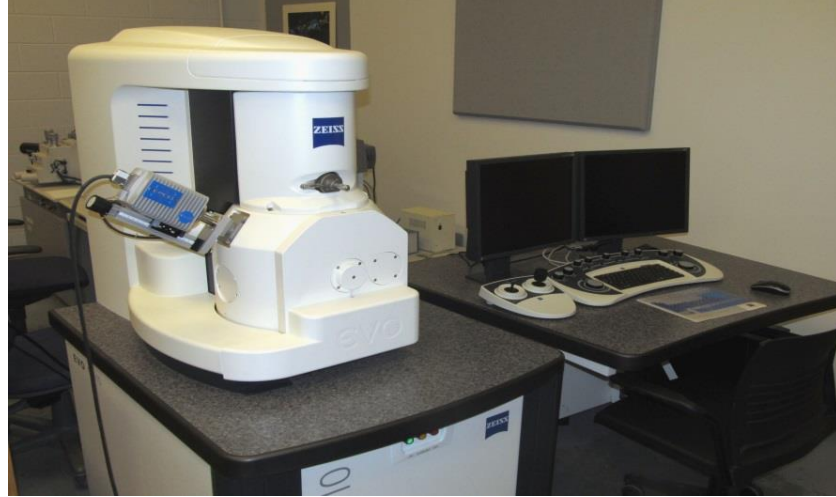
Şekil 6.7: Zeiss Evo40 Taramalı Elektron Mikroskobu.
