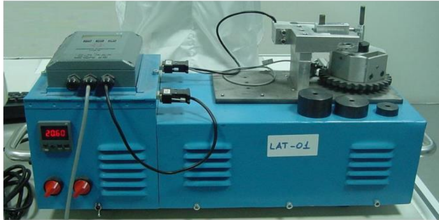
Şekil 6.5: Er-Mir Ball-on-disk aşınma test cihazı.
