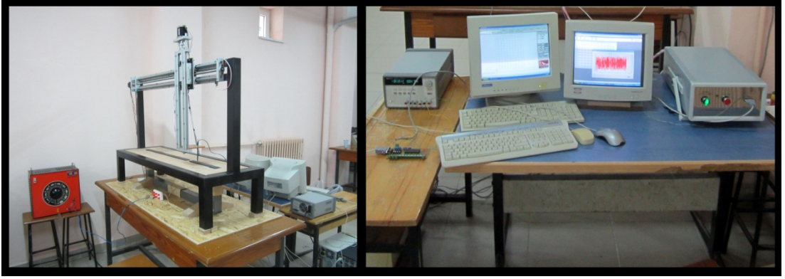
Şekil 4.1: Manyetik 2D tarayıcı sistem ve bu sistemin kontrolünü sağlayan bilgisayar.
