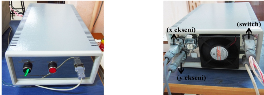
Şekil 2.5: CNC kontrol sistemi.
