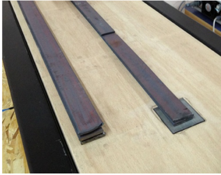
Şekil 2.1: Ferromanyetik örneklerin mıknatıslayıcı çekirdek üzerine yerleştirilmesi.
