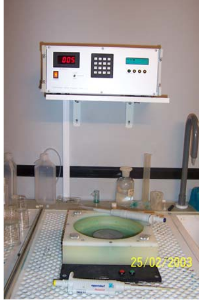
Şekil 3.2: Deneysel çalışmalarda kullanılan dönele kaplama sisteminin bir görünümü
