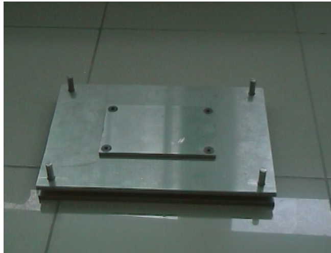
Şekil 7.2 Kompozit plakaların üretimlerinde kullanılan kalıp.
