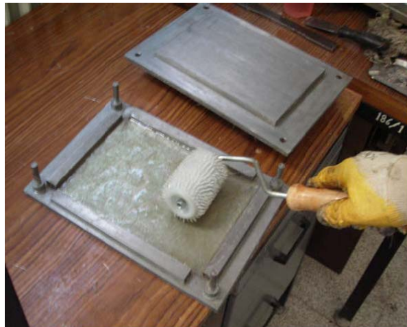
Şekil 7.5 Reçine emdirilmiş cam elyaftan rulo yardımıyla hava kabarcıklarının dışarı atılması.
