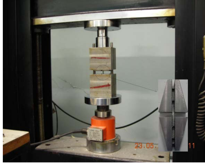
Şekil 6.8 Kompozit malzemenin basma mukavemetinin deneysel olarak bulunması.
