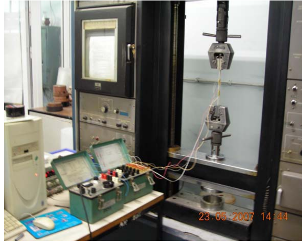
Şekil 6.3 Kompozit numunelerin Young modüllerinin ( E_1, E_2 ) ve Poisson oranlarının ( \nu_{12}, \nu_{21} ) deneysel olarak bulunması.
