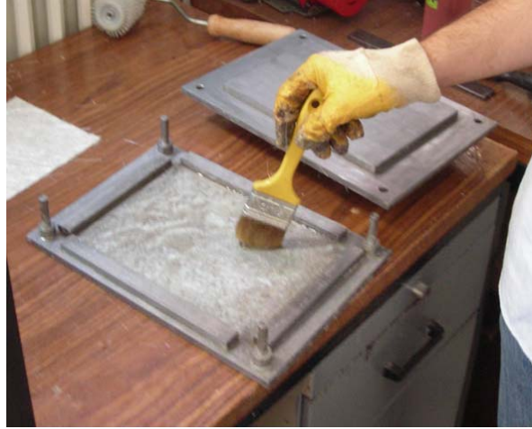
Şekil 7.4 Fırça yardımıyla cam elyafa reçine emdirilmesi.
