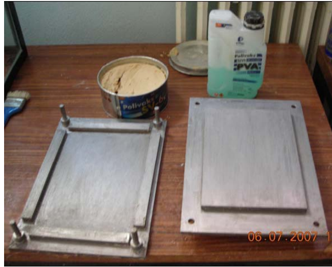
Şekil 7.3 Polivaks ve Polivaks EKO sıvı kalıp ayırıcının kalıp üzerine uygulanması.
