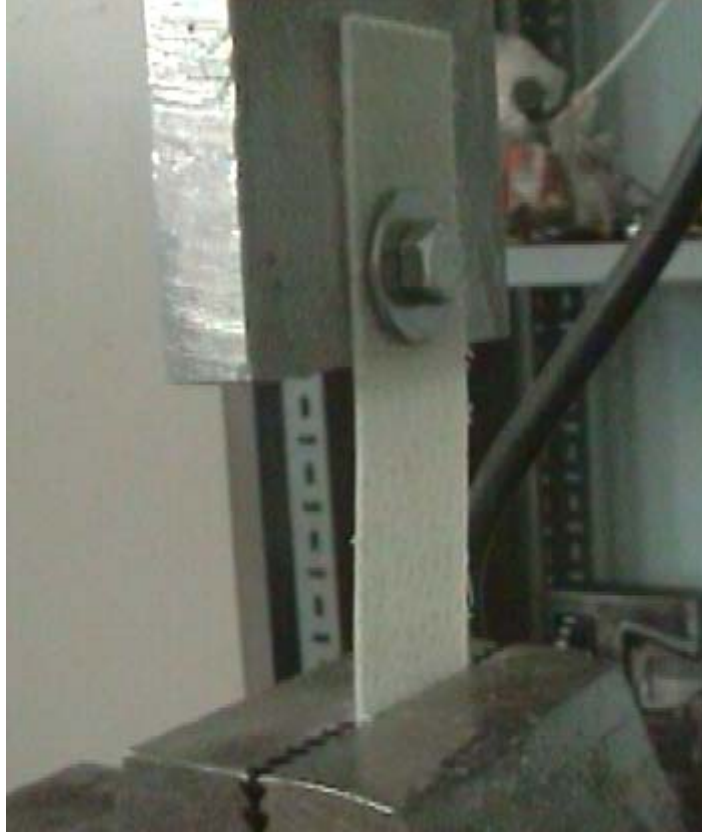
Şekil 7.10 Önyüklemeye momenti uygulanan civata bağlantılı tabakalı kompozit numunenin 1114 Instron çekme cihazında çekme deneyinin yapılışı.
