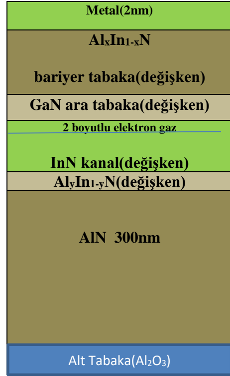
Şekil 4.2: In_{1-x}Al_xN/GaN/InN/In_{1-y}Al_yN yapısının geometrisi.
