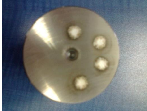
Şekil 4.1: Deneysel çalışmada kullanılan 100Cr6 çelik kütük.
