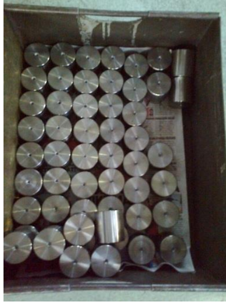
Şekil 4.2: Isıl işlem öncesi hazırlanan 100Cr6 çelik malzemeler.
