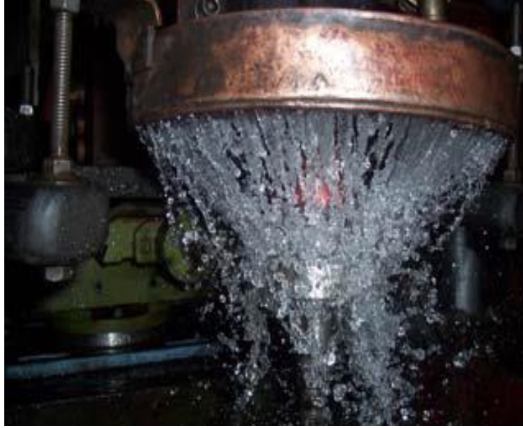
Şekil 3.7: Isıtılan yüzeye soğutma sıvısının uygulanması [40].
